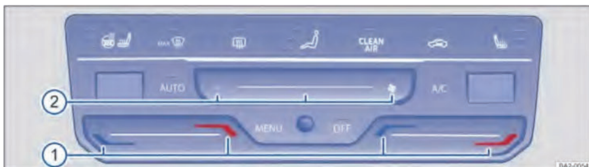
تصویر ۹۳: وسط داشبورد: سیستم تهویه مطبوع تمام اتوماتیک
