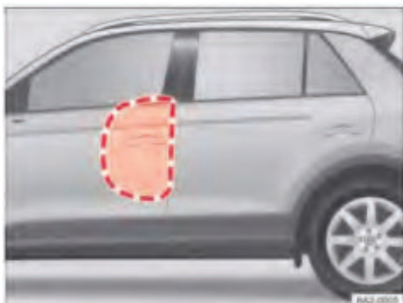
تصویر ۴۱ سمت چپ خودرو: محدوده باز شدن کیسه هوای جانبی
