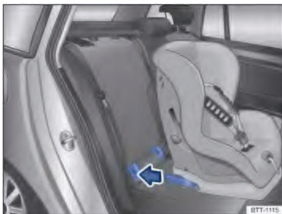
تصویر ۴۷ نصب صندلی کودک ISOFIX با استفاده از بازوی نگهدارنده
