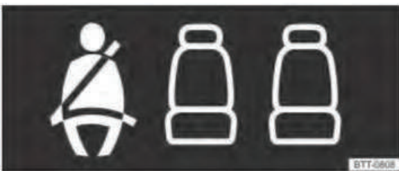
تصویر ۲۸ نمایشگر صفحه کیلومتر: نمایش وضعیت کمربند ایمنی برای صندلی‌های عقب.
