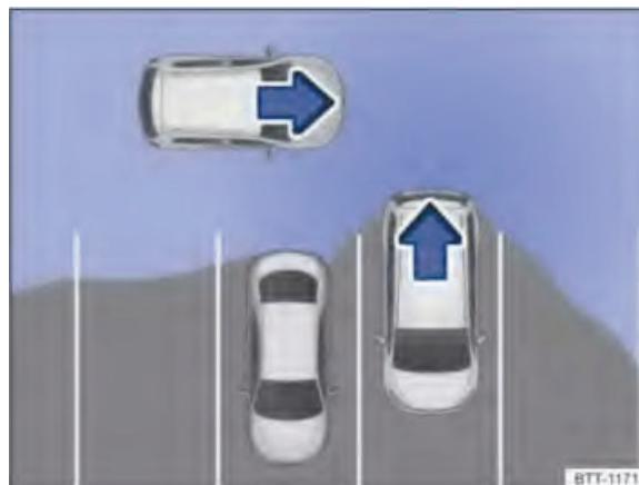
تصویر ۱۳۹ تصویر کمک به خروج از پارک: محدوده نظارتی اطراف هنگام خروج خودرو از فضای پارک
