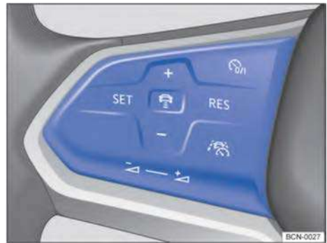
تصویر ۱۱۷ سمت چپ غربلیک فرمان چندمنظوره: دکمه‌های کنترل محدودکننده سرعت (نوع دوم)
