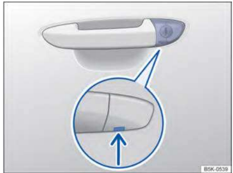
تصویر ۵۶ دستگیره درب راننده: مغزی قفل مخفی درب
