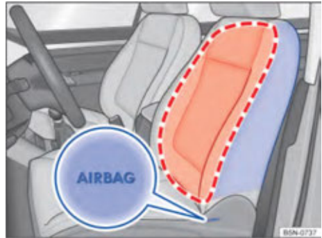
تصویر ۳۴: صندلی جلو سمت چپ: موقعیت نصب کیسه هوای جانبی و محدوده باز شدن آن
