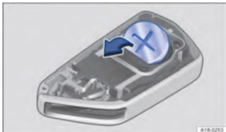
تصویر ۴۷: ریموت خودرو: تعویض باتری
