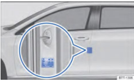
تصویر ۱۶۸: روی ستون درب سمت راننده: برچسب فشار باد لاستیک (تصویر)
