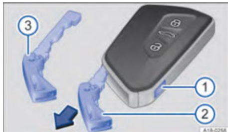
تصویر ۴۵ کلید خودرو: باز کردن قفل کلید اضطراری
