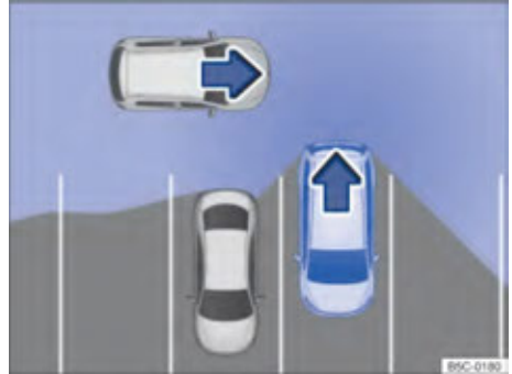
تصویر ۱۱۴: تصویر کمک به خروج از پارک: محدوده نظارتی اطراف هنگام خروج خودرو از فضای پارک
