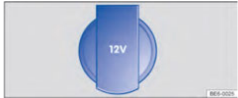
تصویر ۱۲۲: در محفظه نگهداری اشیاء پایین کنسول وسط: سوکت برق ۱۲ ولت (تصویر)
